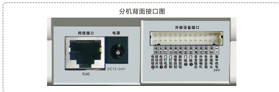
1、**电源接口**：将开关电源（12V~24V）插入电源接口上给分机供电（分机的DC插座极性是“内负外正”）。
